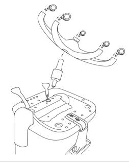
Passo 07: Encaixar a capa do encosto (item 02), através de seu orifício inferior, sobre o \*suporte do mecanismo. Reservar para futura fixação da capa. Obs. A capa ficará apenas encaixada no suporte metálico do mecanismo até o passo 09.
