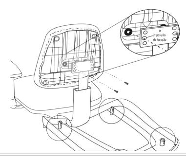
**Passo 09**: Para finalizar a montagem, posicionar a capa do encosto (item 02), já encaixada no passo 07, sobre o conjunto do encosto fixado no passo 08, em seguida pressionar os encaixes para fixá-los.
